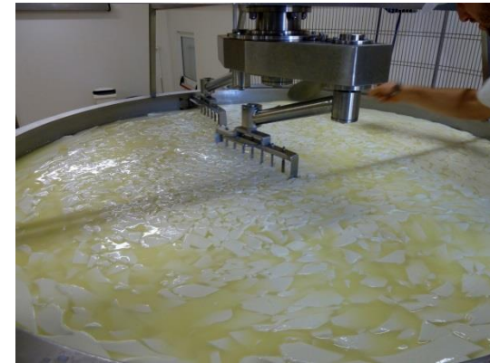
подготовка сырного зерна Käsebruchbereitung
