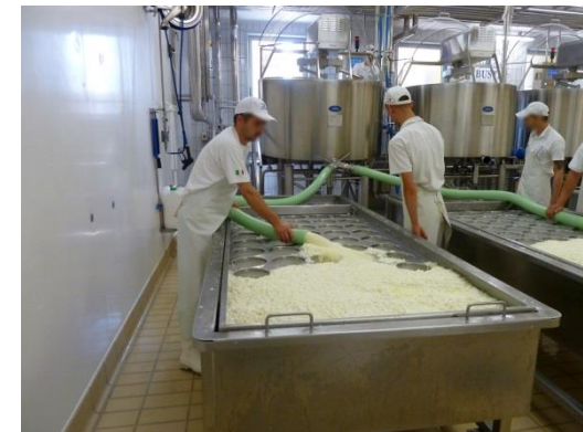
розлив сырного зерна Käsebruchabfüllung
