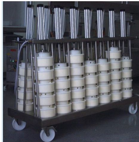
Штапельный пресс для приготовления сыра, возможно использование различных форм для сыра Stapelpresse zur Käseproduktion, Es können verschiedene Käseformen eingesetzt werden
